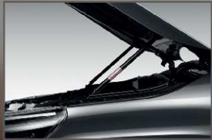
อุปกรณ์ช่วยผ่อนแรงเปิด-ปิด ฝากระโปรงหน้า
